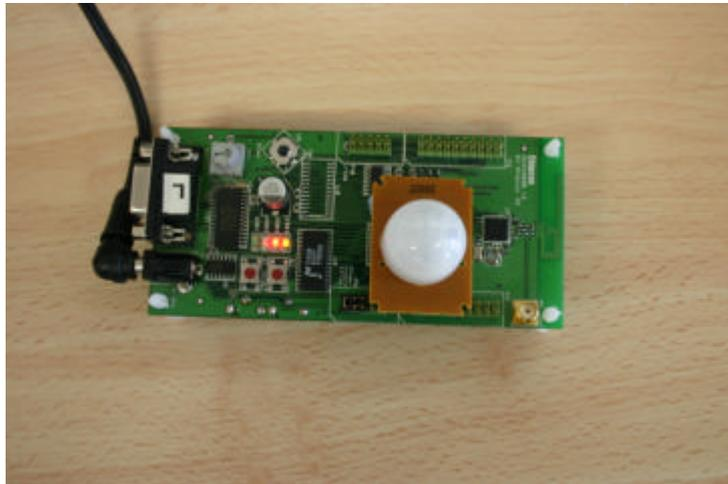
Fig. 4. Dispositivo Zigbee de Chipcom con sensor de presencia
